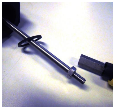
Stap 10 Verbind beide stangen aan elkaar; draai draadeind in de langwerpige zeskantmoer.
