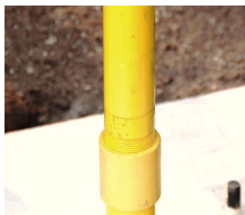
Stap 15 Verbind eventuele volgende pompbuis(zen) met de rvs-stangen aan elkaar. Zie stap 12. Zorg voor een solide verbinding: draai de gele buis stevig in de draadsok.
