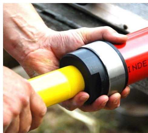
Stap 12 Draai pompbuis vast in de pompcilinder. Let er op dat de rubbering goed aansluit.
