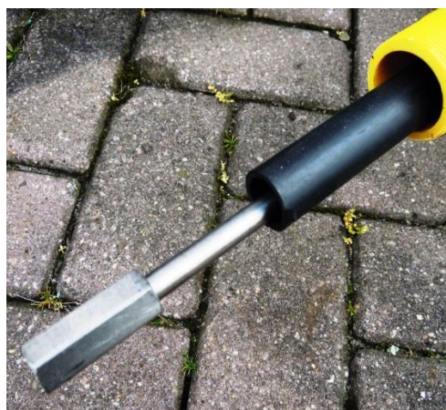
Stap 9 Trek rvs-stang uit de pompbuis.
