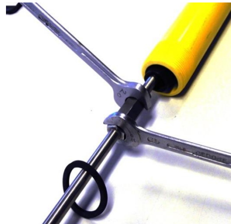
Stap 11 Zorg voor een solide verbinding. Borg door contraoer stevig aan te draaien. Let op juiste plaatsing van de rubber afdichting in buis.
